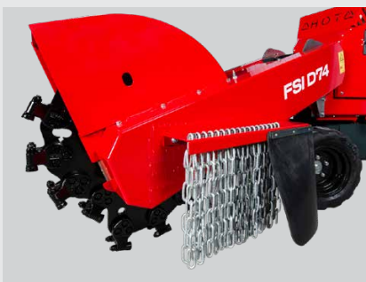
FSI D74 fjerner stubber raskt takket være sitt 735 mm store freserhjul.
