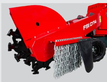
La FSI D74 élimine rapidement les souches grâce à son grand disque de coupe de 735 mm.
