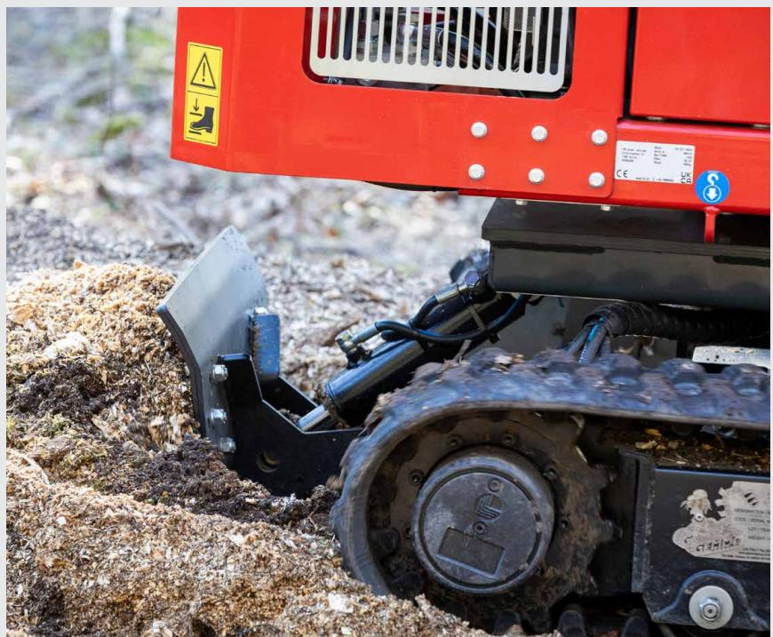
La lame de remblayage facultative facilite le nivellement du sol et le remblayage après le dessouchage, ce qui permet d'obtenir un chantier plus propre et d'aspect professionnel.
