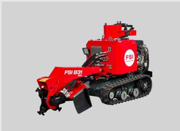
Equipada con un motor de gasolina de 38 CV, la FSI B31-980 ofrece más potencia sin perder el diseño sobresaliente. Mantiene el ancho estrecho, la estabilidad y la maniobrabilidad de la FSI B31-749, con orugas de giro opuesto que aseguran un rendimiento fiable en terrenos variados. La potencia adicional le permite completar los trabajos más rápido mientras se mantiene una operación eficiente.
