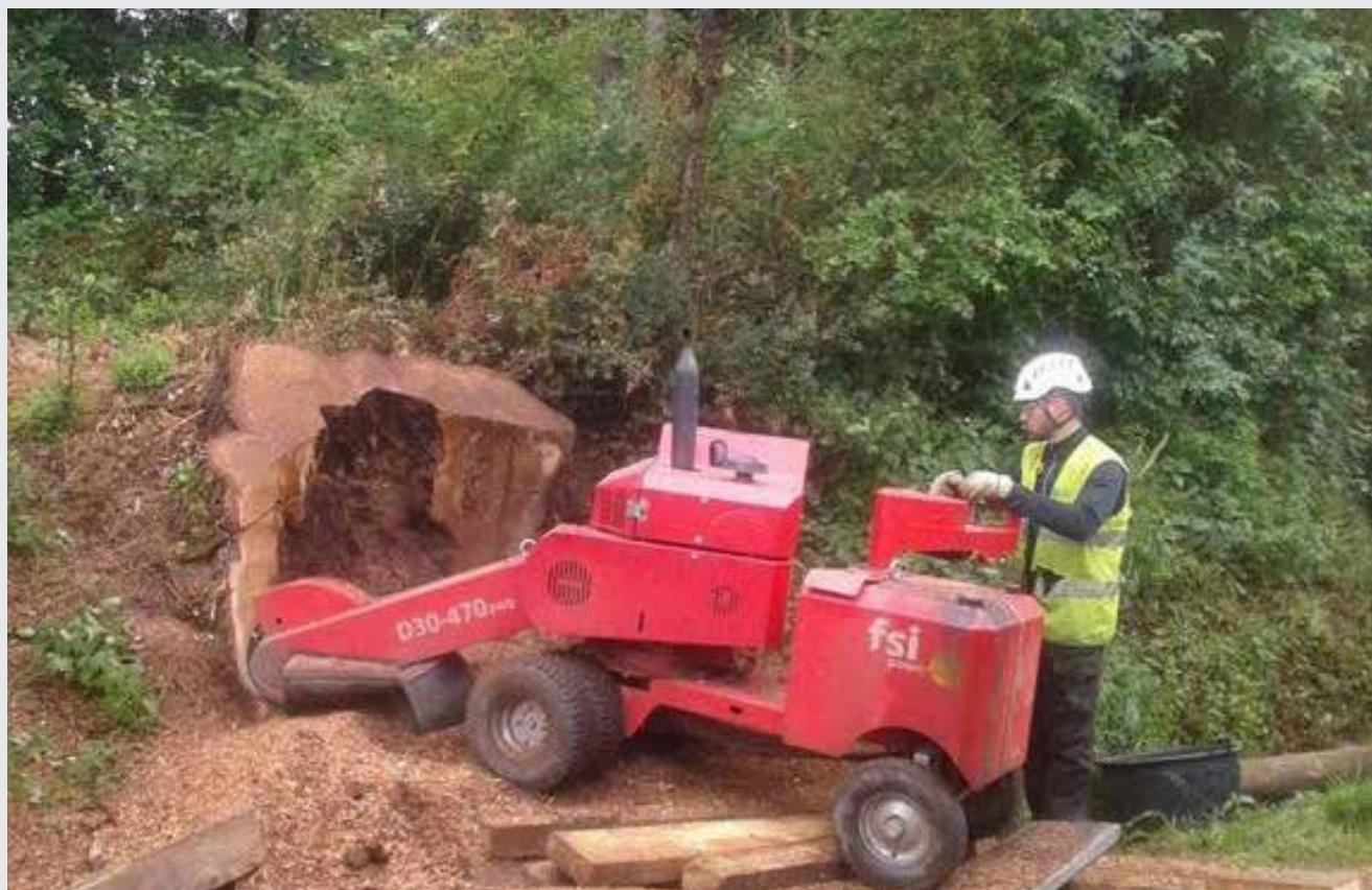
**LAS MÁQUINAS NO SON MONSTRUOS DE GRAN TAMAÑO: POR EJEMPLO, LA POSIBILIDAD DE ELEVAR LA DESTOCONADORA CON UNA GRÚA SOBRE UN MURO, QUITAR LAS RUEDAS DOBLES, MANIOBRAR CON FACILIDAD ALREDEDOR DE LOS TOCONES Y TRANSPORTAR LA MÁQUINA SIN DIFICULTAD LA CONVIERTEN EN UNA HERRAMIENTA ESENCIAL PARA CUALQUIER OBRA.**
