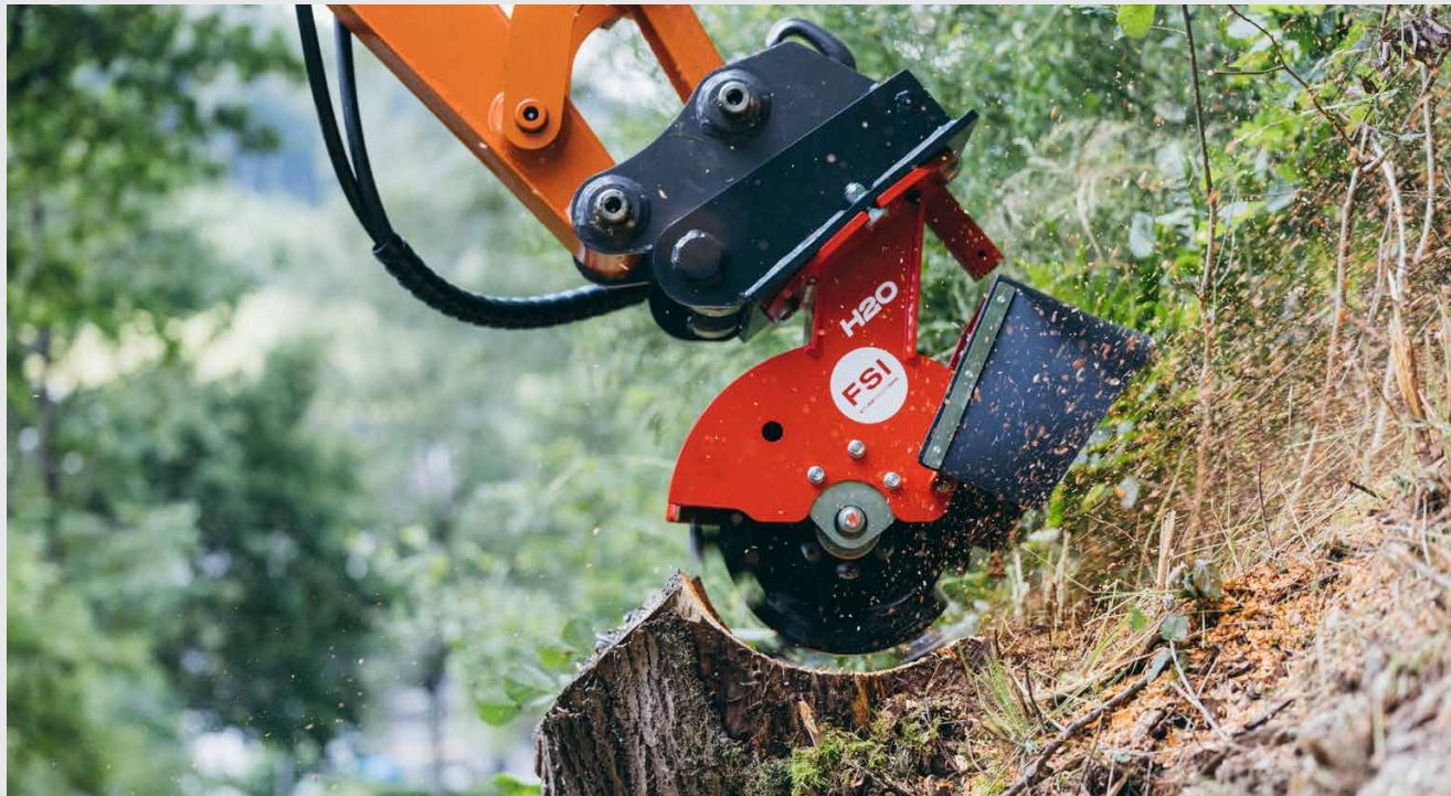
Incrementa la funcionalidad de su excavadora incorporando una destoconadora hidráulica acoplable perfecta para zonas de difícil acceso como pendientes, orillas o detrás de vallas y muros. Nuestra gama es apta para excavadoras de 2-20 toneladas (15-160 CV).
