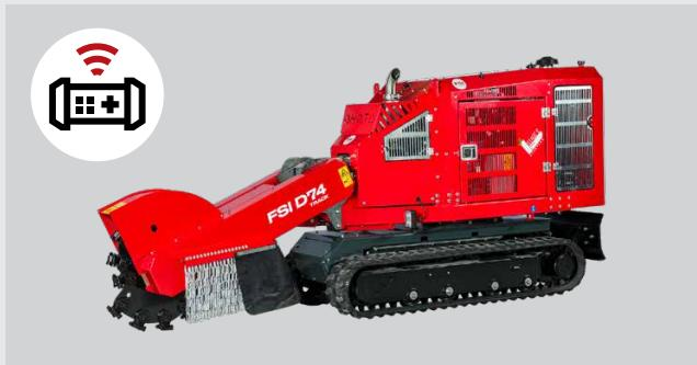
Las orugas de giro opuesto ofrecen una tracción y una maniobrabilidad excelentes incluso en terrenos difíciles. La gran superficie de contacto contribuye a distribuir el peso de la máquina sobre una gran área para limitar los daños en el suelo. Con sus motores de accionamiento de dos velocidades, la FSI D74 TRACK cuenta con FSI power-drive, lo que permite a los operarios elegir entre la velocidad HI para un movimiento más rápido y la velocidad LOW para una capacidad de tracción mayor.
