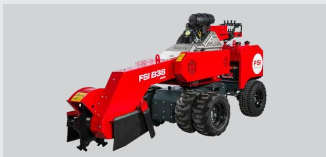
La FSI B38 4WD incluye características del modelo 2WD, pero también incorpora FSI power-drive, un sistema de tracción de 2 velocidades. Este sistema permite a los usuarios elegir entre 2WD HI para largos recorridos a una mayor velocidad y 4WD LOW para una tracción superior durante el desplazamiento por el terreno o el corte de tocones.
