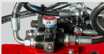
Si fuera necesario, el caudal hidráulico para el barrido se puede ajustar para adaptarse a los diferentes niveles de dureza de la madera.
