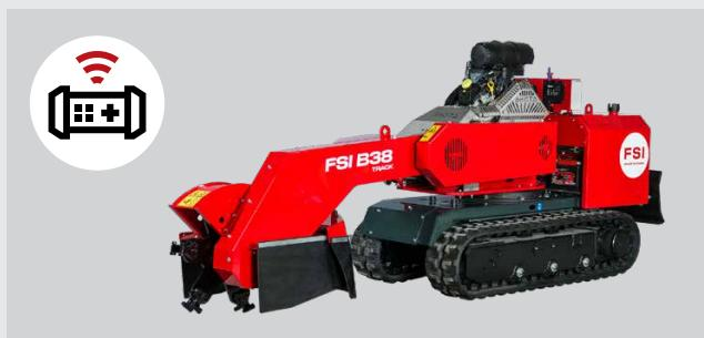
Al igual que la FSI B38 4WD REMOTE, el modelo TRACK está equipado con un sistema de control remoto que garantiza que todas las funciones estén a mano a la hora de cortar tocones. Un juego de orugas de giro opuesto ofrece una maniobrabilidad y una tracción mejoradas en terrenos difíciles. Además, puede retraerse para atravesar puertas de jardín estrechas.
