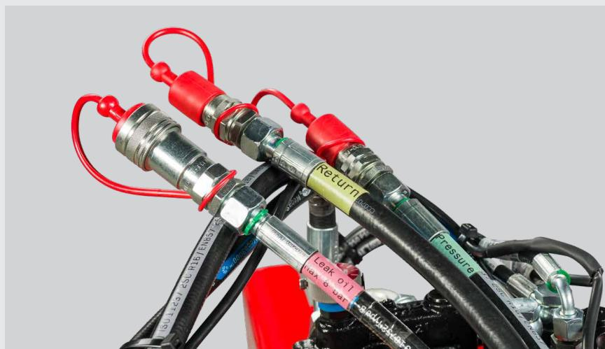
*Nota: Las destoconadoras hidráulicas FSI precisan de una conexión de retorno de flujo libre.*
