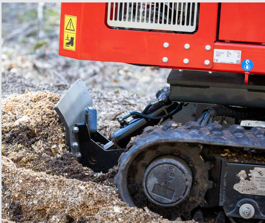
Dozerbladet, der fås som ekstraudstyr, gør det nemmere at nivellere underlaget og efterfylde, når stubben er fjernet, hvilket efterlader et ryddet arbejdsområde og giver indtryk af professionelt udført arbejde.
