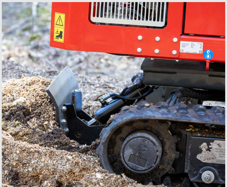
Der optionale Planierschild erleichtert das Einebnen und Auffüllen des Bodens nach der Entfernung des Stumpfes und hinterlässt einen sauberer, professioneller aussehenden Arbeitsplatz.
