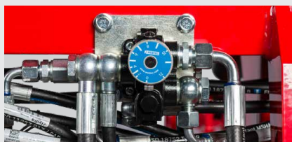
Upravte rychlost výkyvu, aby odpovídala průtoku hydraulické kapaliny traktoru a tvrdosti dřeva pařezu.
