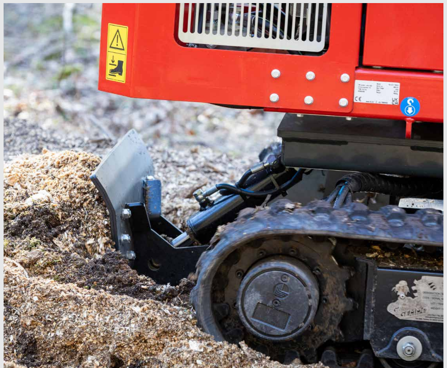
Volitelná radlice usnadňuje zarovnání povrchu země a zaplnění otvoru po odstranění pařezu, takže po frézování zůstane místo čistší a profesionálně vypadající.
