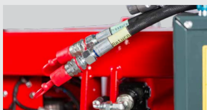
Hydraulické přípojky a elektrické konektory jsou součástí stroje a jsou zřetelně označeny.
